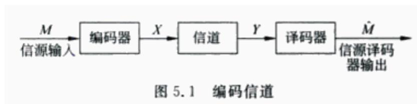
在普通信道的输入和输出端连接编码器和译码器，形成的新信道称作编码信道。
