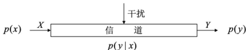
由于干扰的存在，信道的输出  $Y$  与输入  $X$  不一定完全相同，用条件概率  $p(y|x)$  描述。
