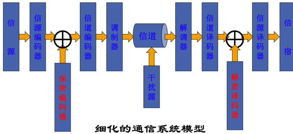
说明：假设信道是无干扰的。对于有干扰信道，可根据香农第二定理，在信道输入输出端分别加入信道编解码，构成广义的无干扰信道。
